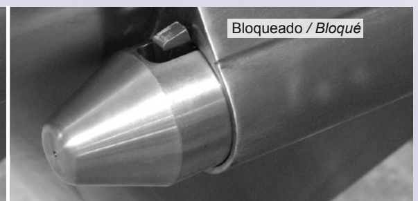
Bloqueo automático del bin / Blocage automatique du conteneur
